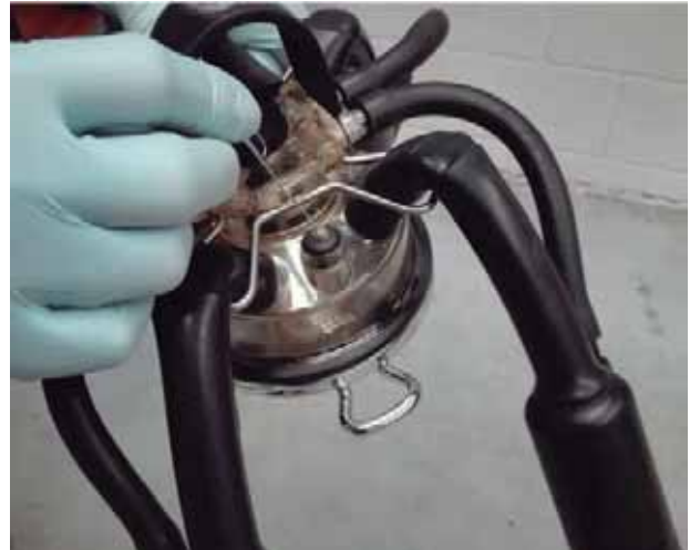
Figura 3. Limpieza del orificio de ventilación del colector
